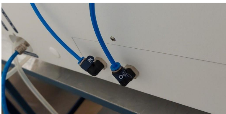
Obrázek 23.1 Připojení hadičky na zvlhčovací lahvi a vícekomorovém inkubátoru IVF MIRI® Humidity
